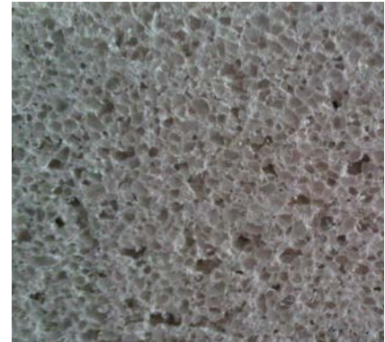
Doorsnede van Aerogel/Perliet isolatiestuc met volledige doorharding
